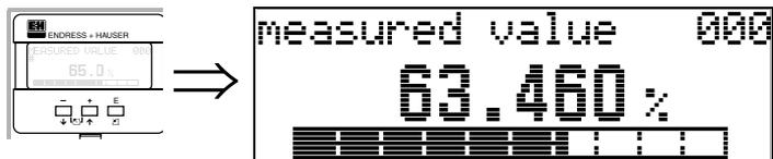
Эта функция отображает текущий измеряемый параметр в выбранных единицах см. функцию "customer unit" (042)). Количество цифр после десятичной запятой м. б. выбрано в функции "no.of decimals" (095). Длина гистограммы соответствует величине настоящего измеряемого параметра относительно диапазона измерений.
