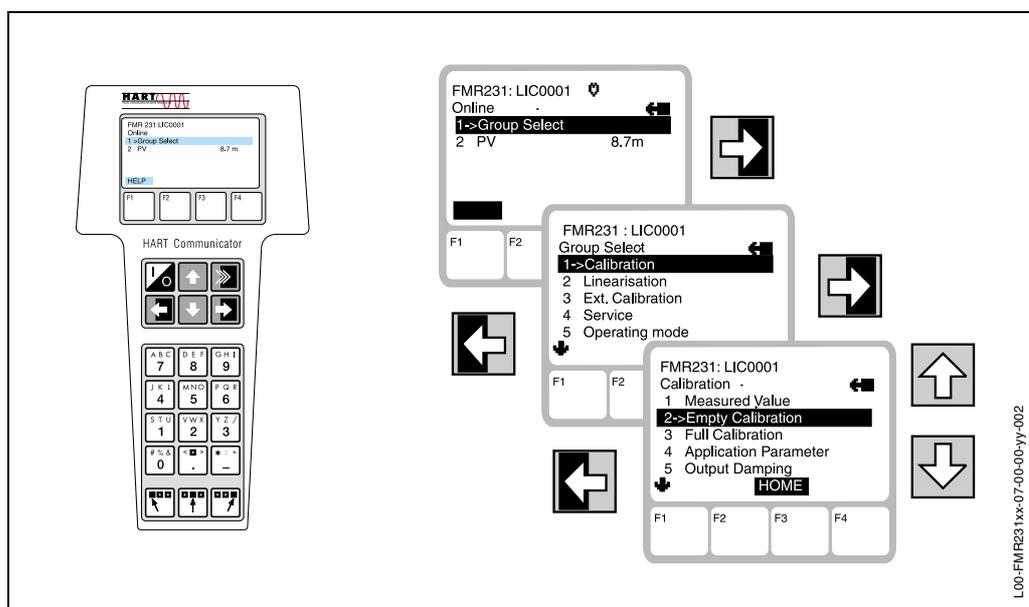
Рис. 5 Режим меню с переносным прибором DXR 275
