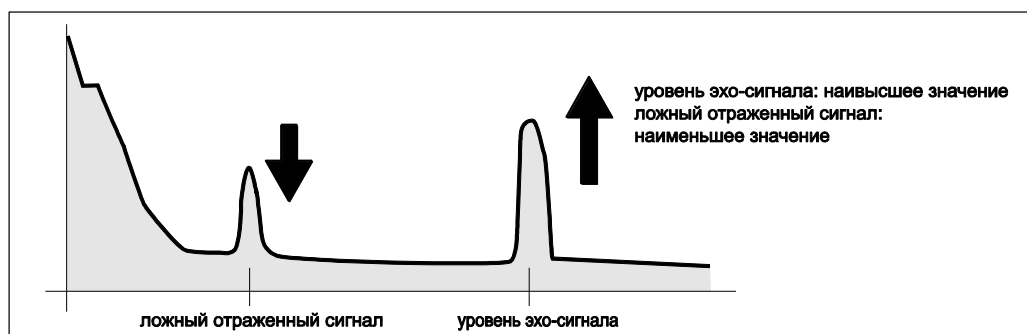
Резервуар частично заполнен, получен паразитный эхо-сигнал:
