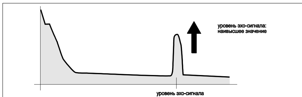
Резервуар частично заполнен, паразитный эхо-сигнал не получен
