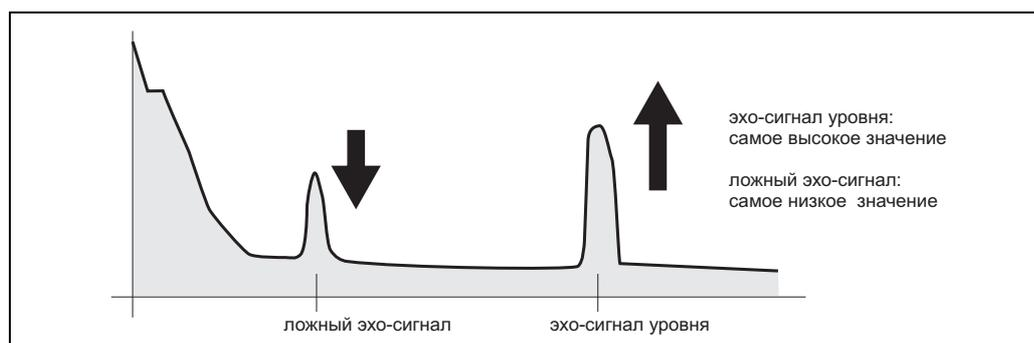
Резервуар частично заполнен, присутствуют паразитные эхо-сигналы
