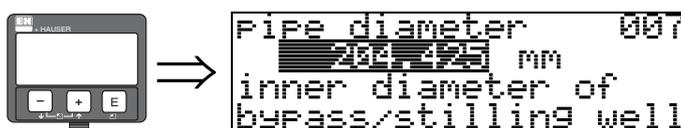
Эта функция используется для ввода диаметра направляющей трубы или трубы байпаса.
