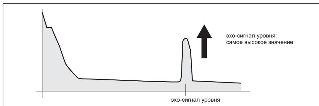
Резервуар частично заполнен, паразитные эхо-сигналы отсутствуют
