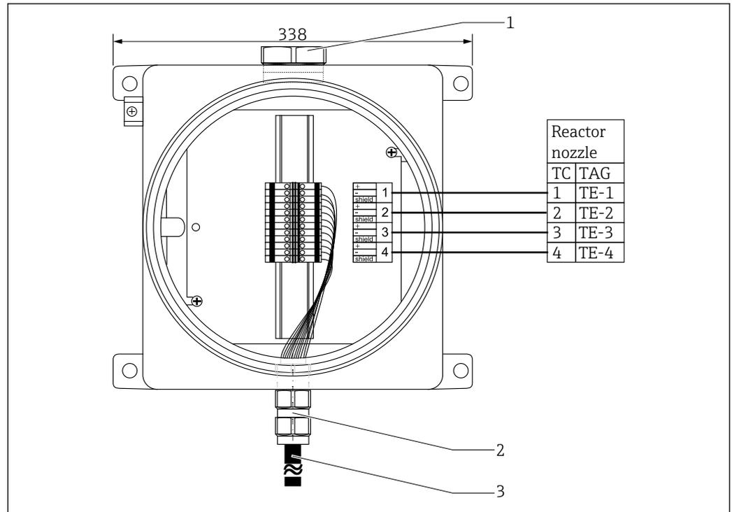
1 Вариант подключения кабеля TS901 с четырьмя вставками термопар 1xK МЭК 60584, с экранированным удлинительным кабелем в распределительной коробке
