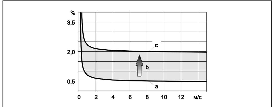
Пример погрешности измерения в трубе с номинальным диаметром DN > 200 (8")
