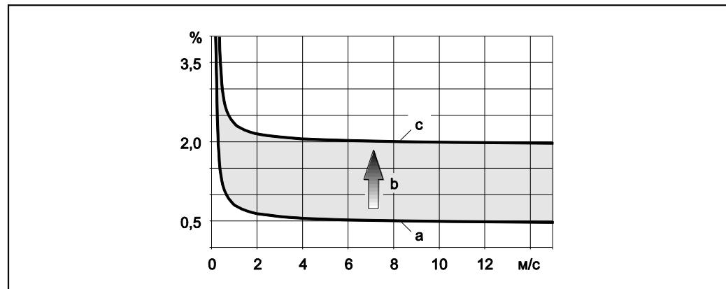
Пример погрешности измерения в трубе с номинальным диаметром DN > 200 (8")
