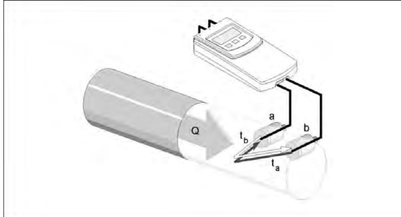
Принцип измерения на основе разницы времени прохождения
