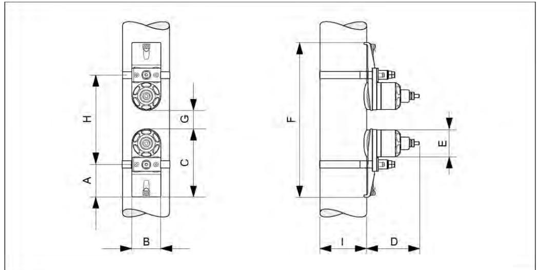
*Вариант монтажа для измерения на основе двукратного прохождения сигнала*
