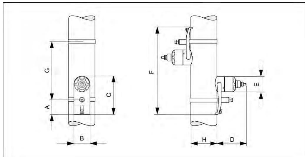
*Вариант монтажа для измерения на основе однократного прохождения сигнала*
