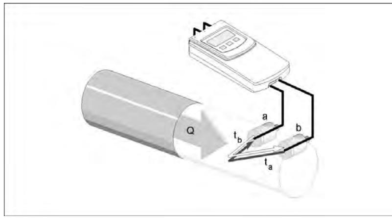
Принцип измерения на основе разницы времени прохождения
