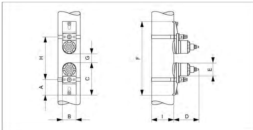
*Вариант монтажа для измерения на основе двукратного прохождения сигнала*
