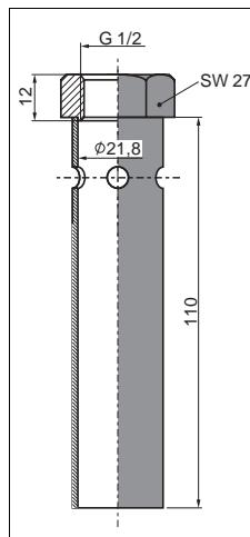
Размеры трубы для защиты температурного датчика от непогоды
