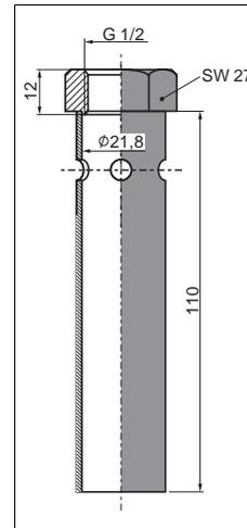
Размеры трубки для защиты температурного датчика от непогоды
