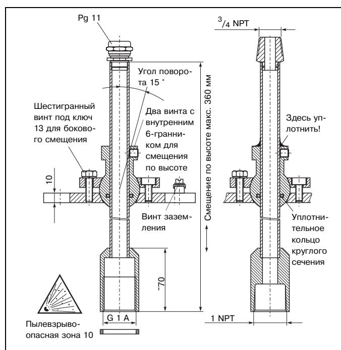
Размеры позиционирующего устройства FAU 40
