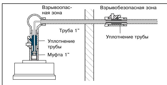
Датчик на трубе 1" в пылевзрывобезопасной зоне 10 (FM, Class II)
