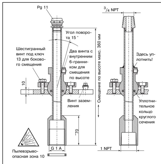
Размеры позиционирующего устройства FAU 40
