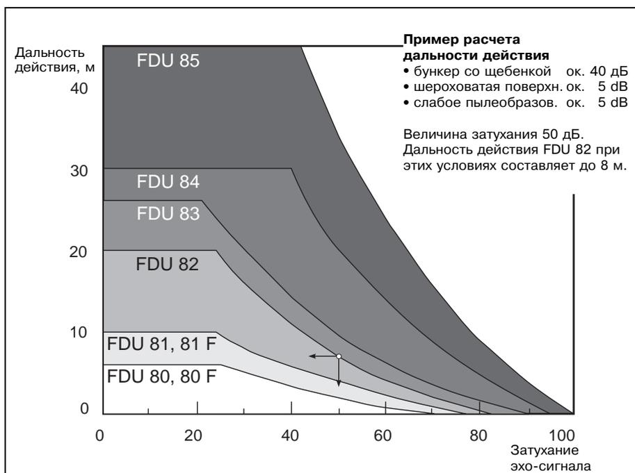
Затухание эхо-сигнала как функция дальности действия различных датчиков (при идеальных отражении и атмосфере)
