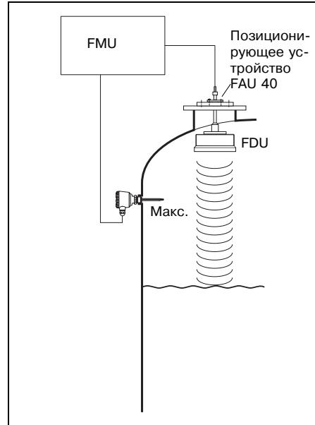
Измерительный преобразователь имеет отдельный вход для сигнализации предельного значения
