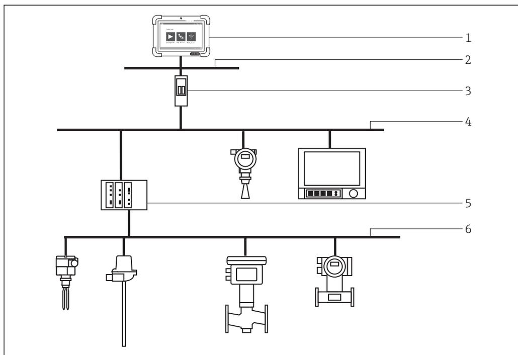
7 Соединение PROFIBUS типа «точка-шина» через Fieldgate SFG500
