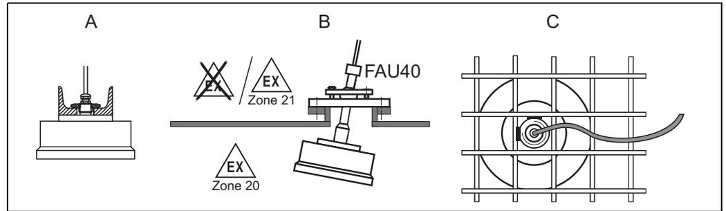
**A:** на швеллере или уголке; **B:** с позиционирующим устройством FAU40; в ATEX Zone 20 позиционирующее устройство может использоваться для зонального разделения; **C:** с 1" муфтой приваренной к решетке
