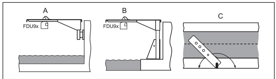
**A:** Монтаж с консолью и настенным кронштейном; **B:** Монтаж с консолью и монтажной стойкой; **C:** Консоль может быть поворачиваться для размещения датчика по центру канала.
