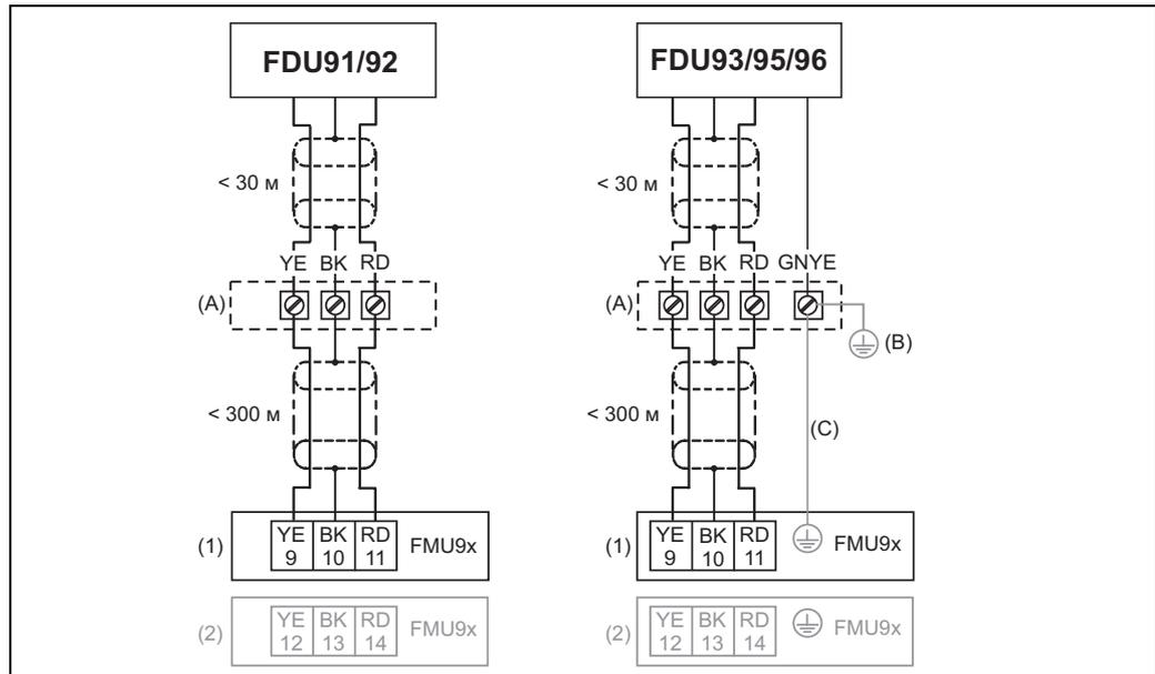
(A): Терминальная коробка (рекомендуется при длине кабеля > 30 м); (B): Заземление в терминальной коробке; (C): Заземление в преобразователе или диспетчерской; (1): Терминалы для входа датчика 1 в FMU9x; (2): Терминалы для входа датчика в FMU9x (опция)
