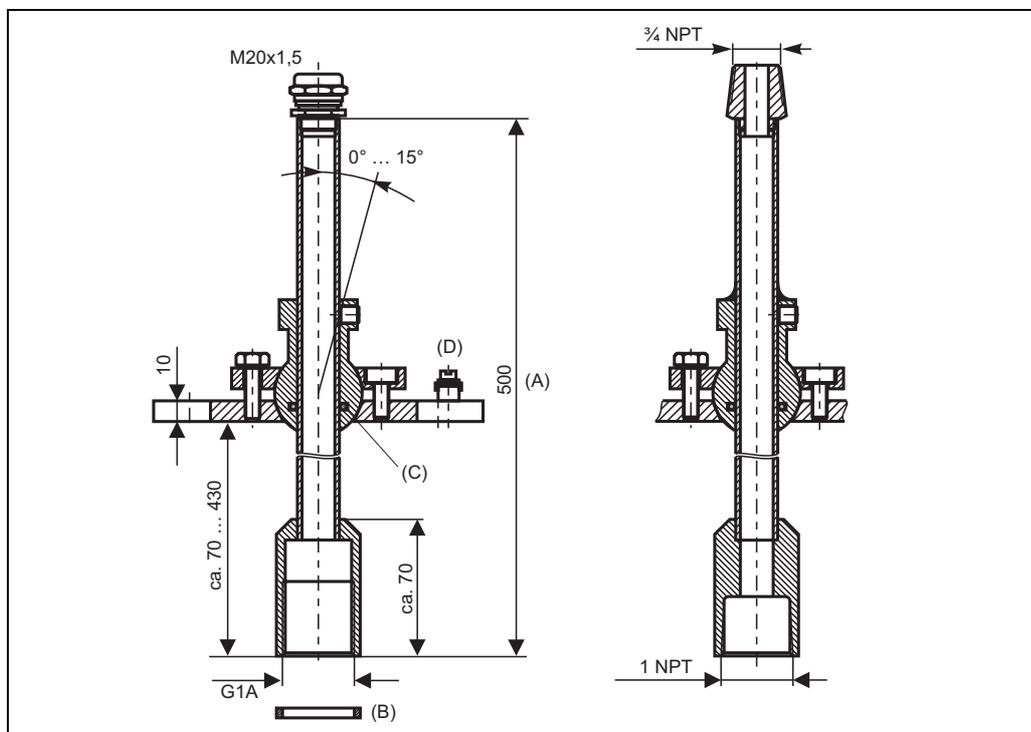
(A): Общая длина 500 мм; подстройка 360 мм; (B): для применения в ATEX Zone 20: вставьте здесь уплотнение, которое поставляется с датчиком; (C): кольцевое уплотнение в сферическом соединении для изоляции от процесса; (D): Заземление может быть выполнено непосредственно через винт заземления.
