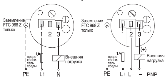
Рис. 7 Слева: вариант исполнения для переменного тока Справа: вариант исполнения для постоянного тока
