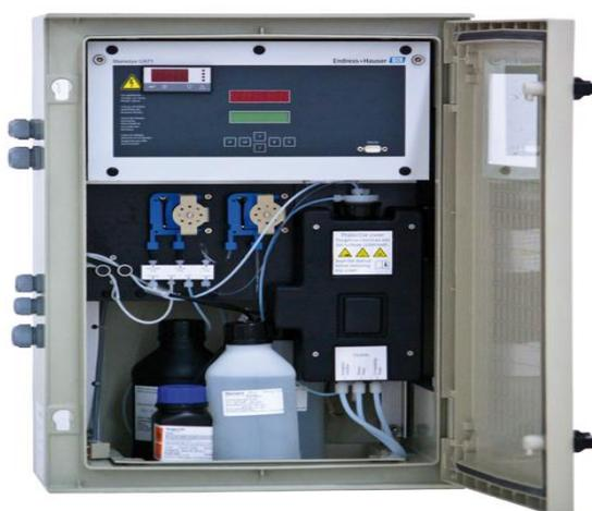
Фотография общего вида анализатора химического потребления кислорода (ХПК)
