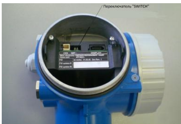
Рисунок 4. Переключатель «SWITCH» для защиты от несанкционированного доступа к настройкам.
