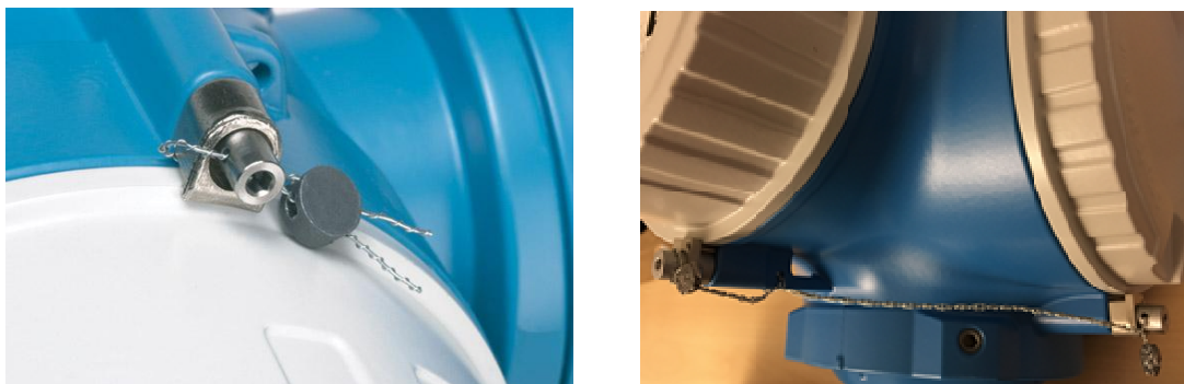
Рисунок 3 - Пломбирование корпуса измерительного преобразователя
