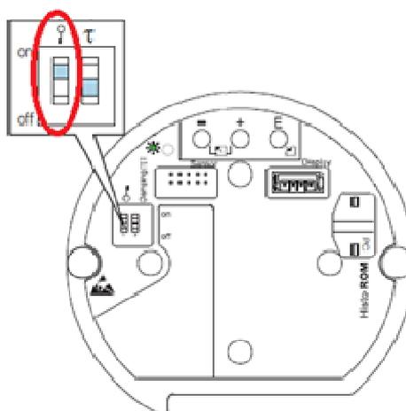
Рисунок 7 - Переключатель для защиты от несанкционированного доступа к настройкам преобразователей Deltabar S PMD75, Deltabar S FMD77, Deltabar S FMD78
