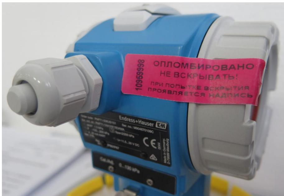
Рисунок 5 - Схема пломбирования корпуса преобразователя
