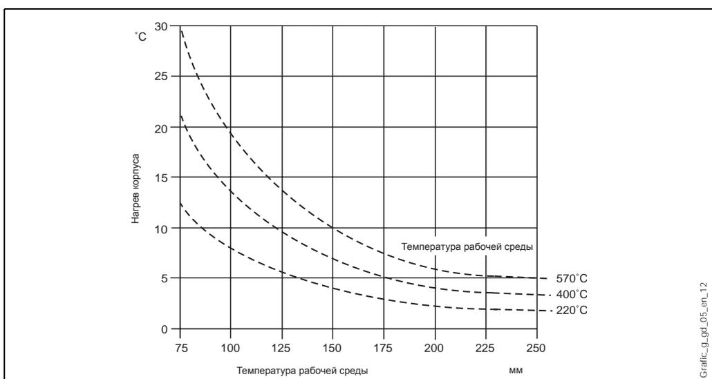
Рис. 8: Температура внутри корпуса в зависимости от температуры рабочей среды
