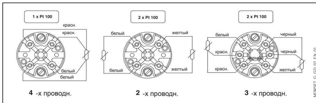
Рис. 12: Стандартные схемы подключения (керамический блок разъемов)
