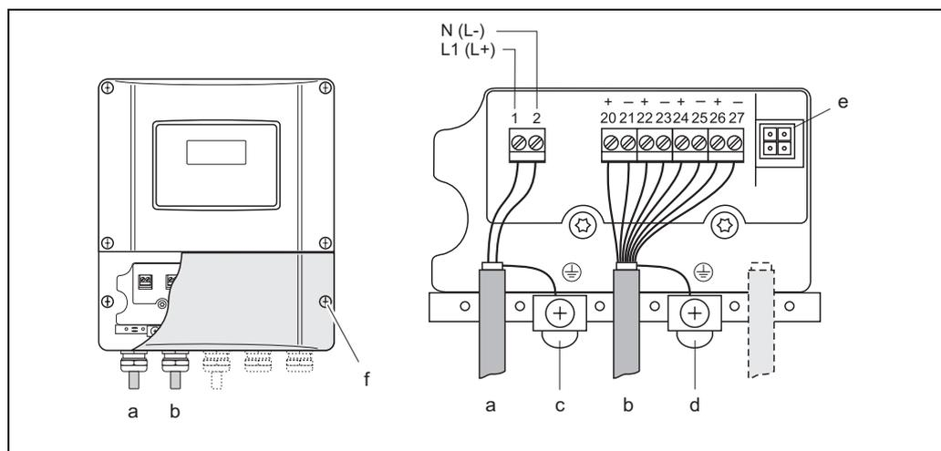
Подключение трансмиттера (настенный корпус). Площадь поперечного сечения кабеля: макс. 2,5 мм<sup>2</sup>
